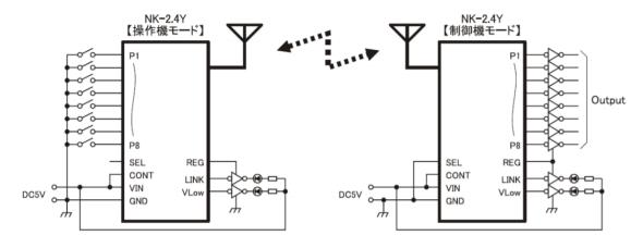
ペアリングを行う場合、PM 端子を GND に接続する必要がありますので、PM 端子を GND に接続できるように SW 等を取り付ける必要があります。
