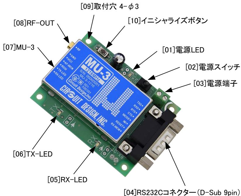
**[01]電源 LED:** 電源スイッチを投入すると点灯します。
