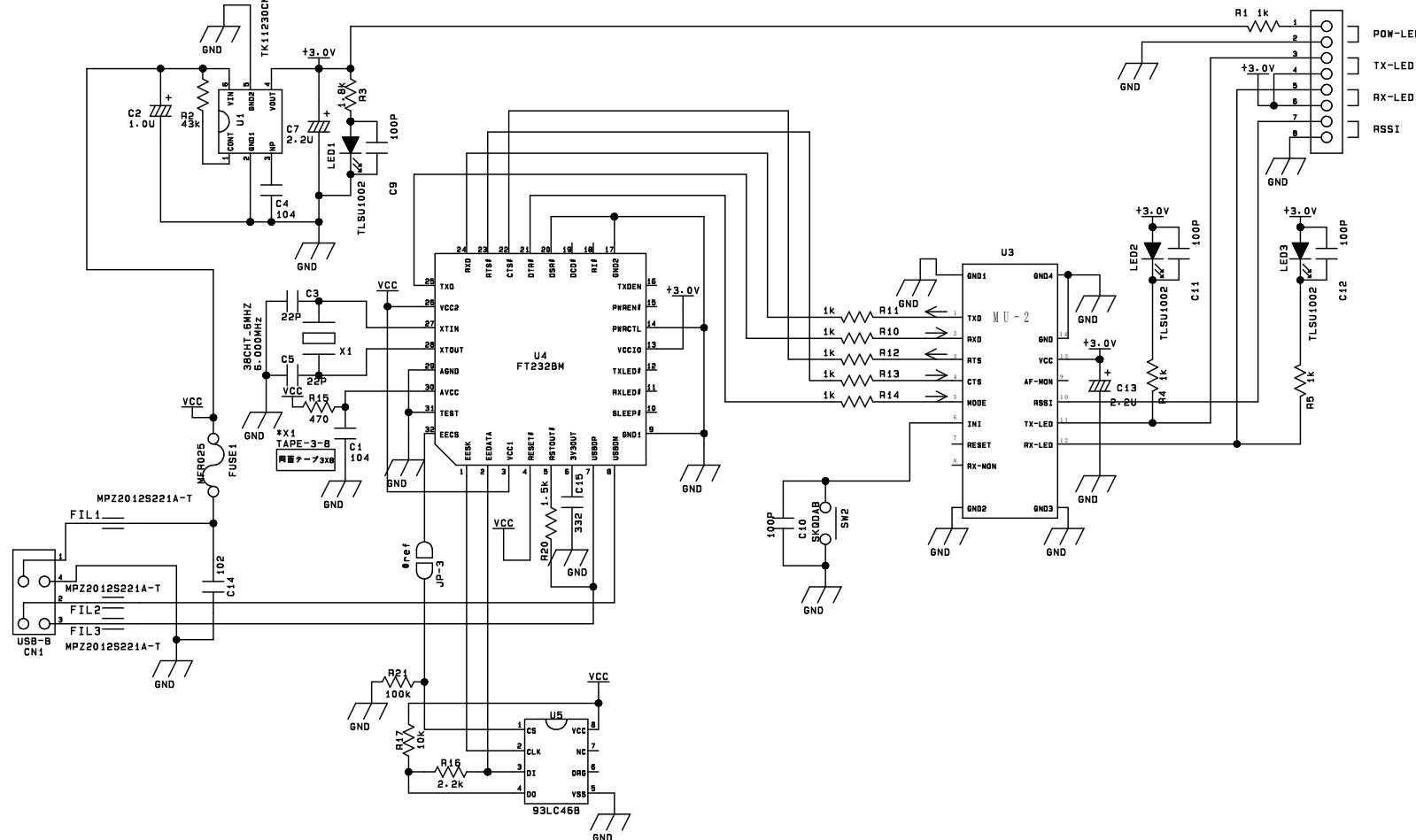
※本回路図を元にユーザー基板を作成する場合は、USB チップ周辺及びインターフェースからの高周波ノイズに十分注意して下さい。
