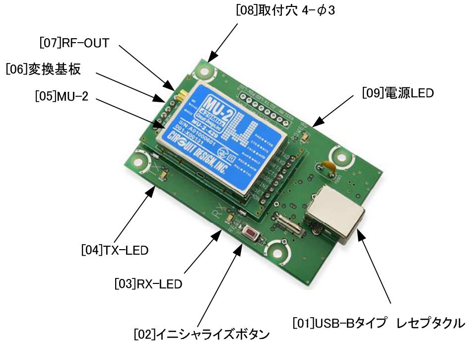
**[01]USB-B レセプタクル:**2重シールド USB ケーブル(USB2.0 ハイスピード対応ケーブル)を接続して下さい。
