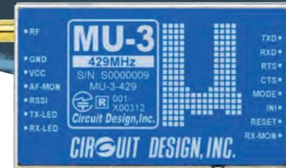
ワンチップCPUのUARTやパソコンのCOMポート(RS232C)とインターフェース可能なコマンドコントロールの無線モデムです。
