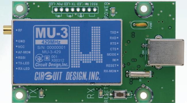
MU-3はRS-232CおよびUSBのインターフェースボードを用意しています。インターフェースボードを制御可能な評価プログラムもあります。インターフェースボードと評価プログラムをお使いいただければ、システム開発の初期段階でMU-3を簡単に評価することができます。
