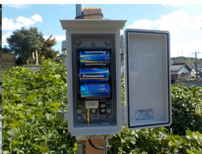
LoRa送信機保護ケース内部 単1乾電池3本で1年間稼働
