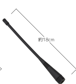
防水ホイップアンテナ ANT-400-SWW SMA_FF-18 利得: 2dBi以下 全長: 約18cm
