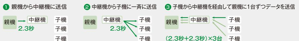
中継機を経由する子機と、経路しない子機が混在する場合も、親機1台に対して、子機は合計で63台まで接続できます。データ送信は、中継機を経由しない子機のデータ収集が先に行われます。それらが完了した後に経路する子機のデータを収集します。
