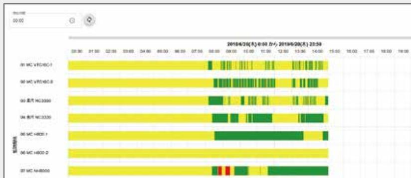
現在の機械稼働状態(ガントチャート)を表示します。
