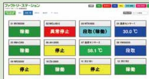
各種センサーを利用して収集したアナログデータを画面に表示できます。
