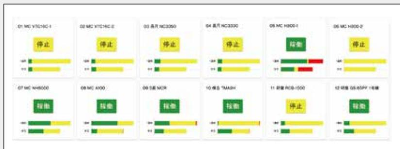
現在の機械稼働状態をアンドン表示します。
