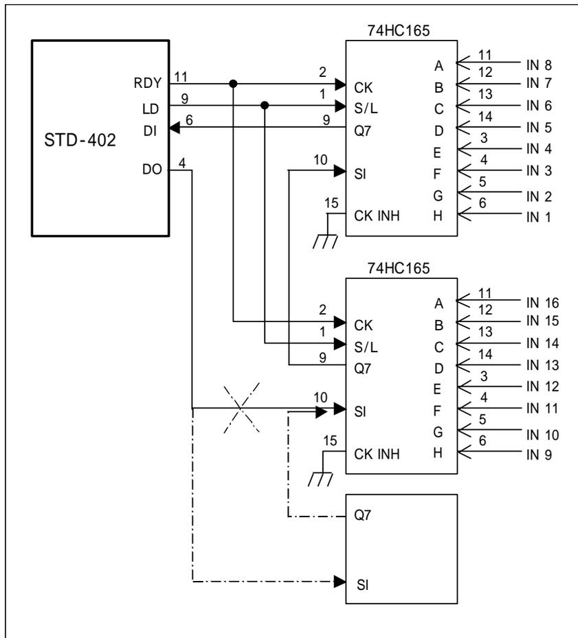
IC を増設する場合は上図の様に最終の IC の SI と STD-402 の DO と Q7 を次の IC の SI に接続してください。
