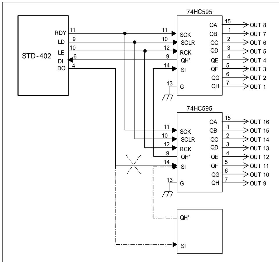
IC を増設する場合は上図の様に最終の IC の SI と STD-402 の DO を、QH' を次の IC の SI に接続してください。
