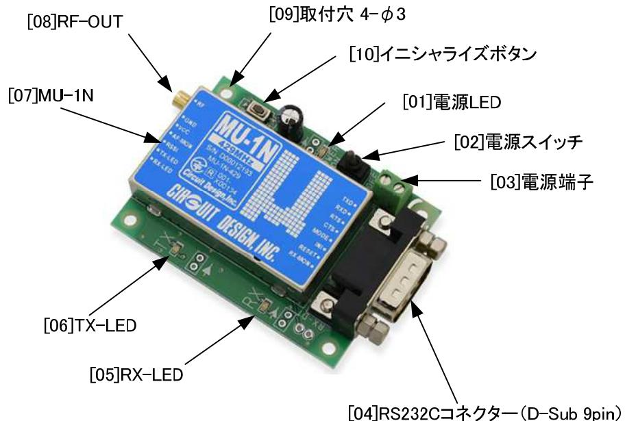
**[01]電源 LED:** 電源スイッチを投入すると点灯します。
