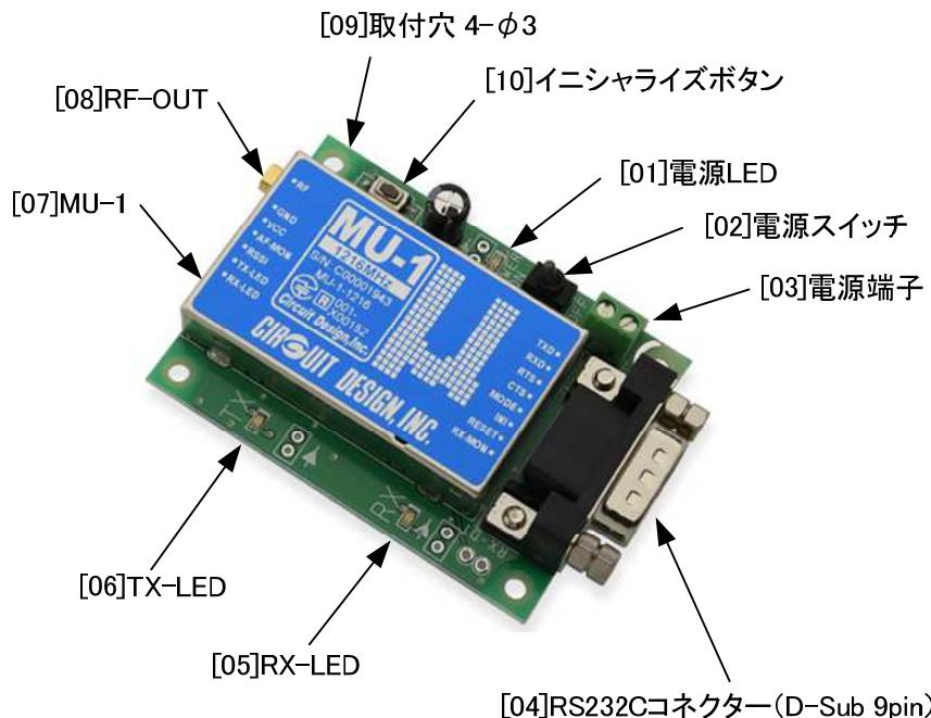
**[01]電源 LED:** 電源スイッチを投入すると点灯します。
