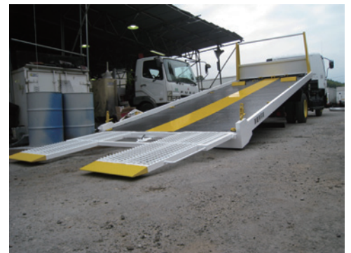
制御例：積載車/スライドローダー
